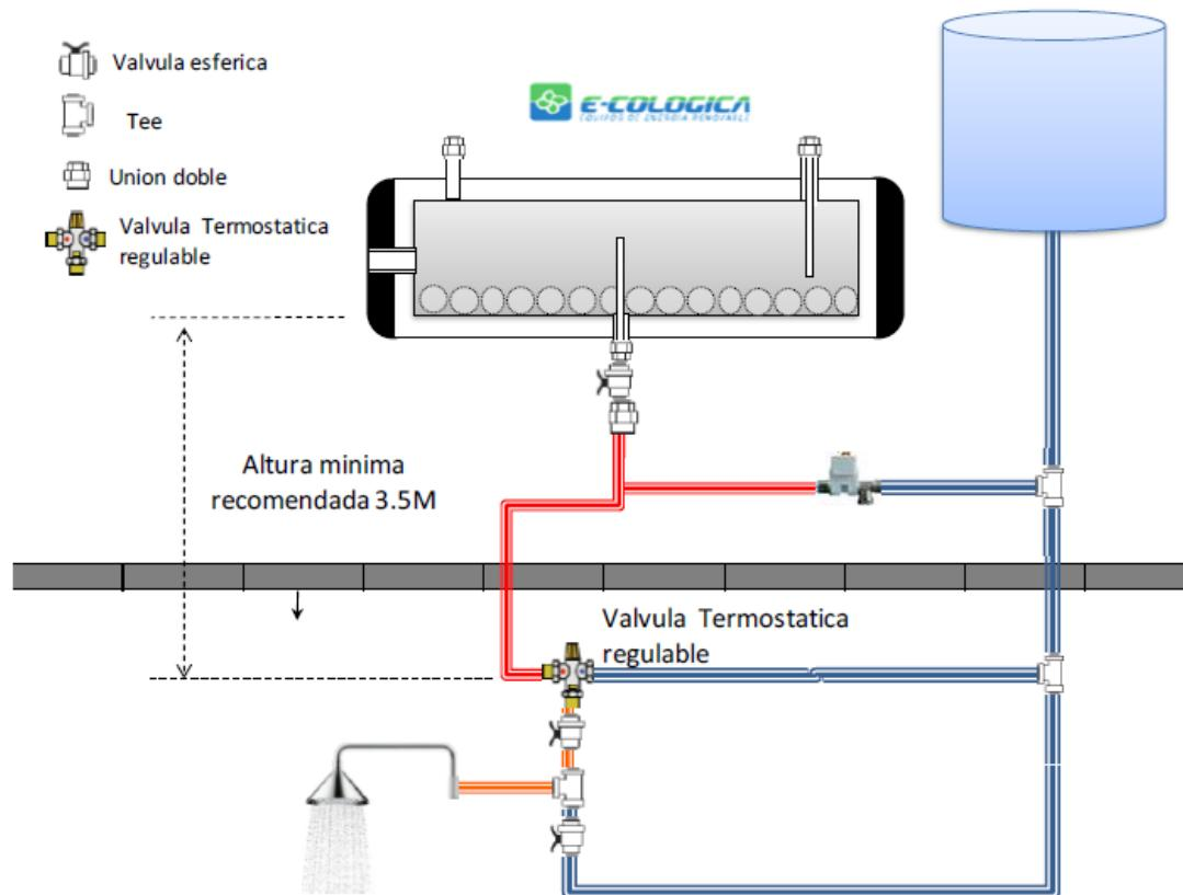
La válvula termostática requiere una presión mínima para trabajar y que la presión del agua fría y caliente sea similar, para esto recomendamos que la conexión se realice como indica el diagrama con una altura de 3,5M entre el termotanque y la válvula y que se utilice el tanque de agua elevado para proveer de agua fría.
