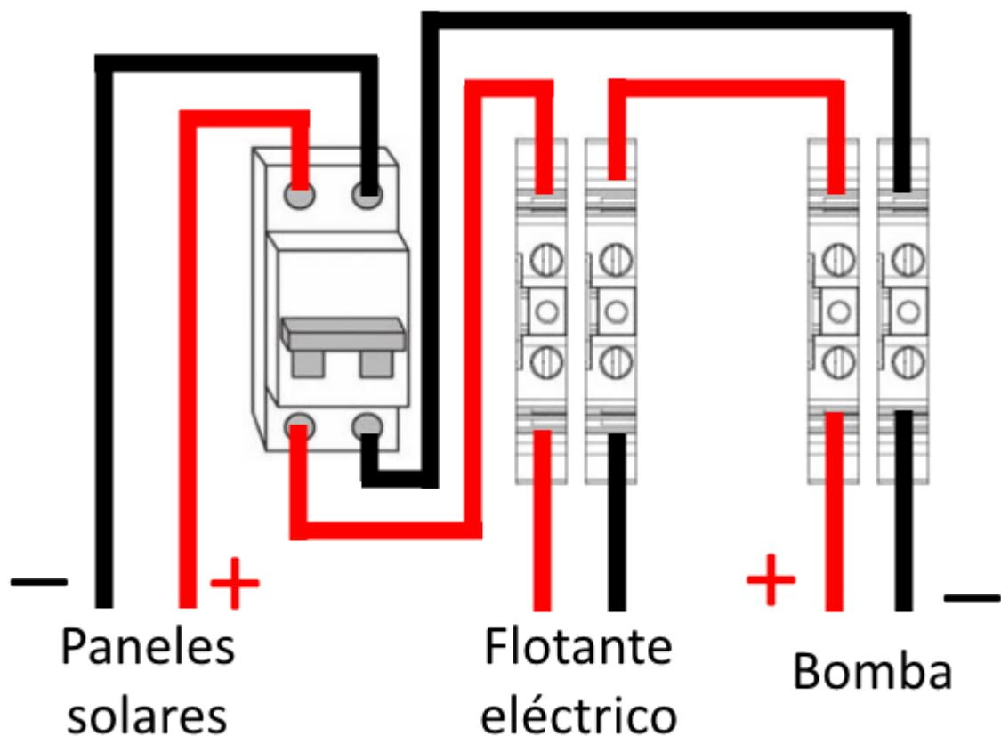
Se pueden utilizar una llave termomagnética de 20A para apagar la bomba.
