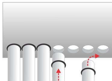
5. Repetir la misma operación en el extremo opuesto del tanque. Una vez colocado el 2do. tubo rotar el tanque con sumo cuidado hasta lograr que los 2 tubos queden orientados en forma paralela a los postes delanteros (piezas A1 y A2)
