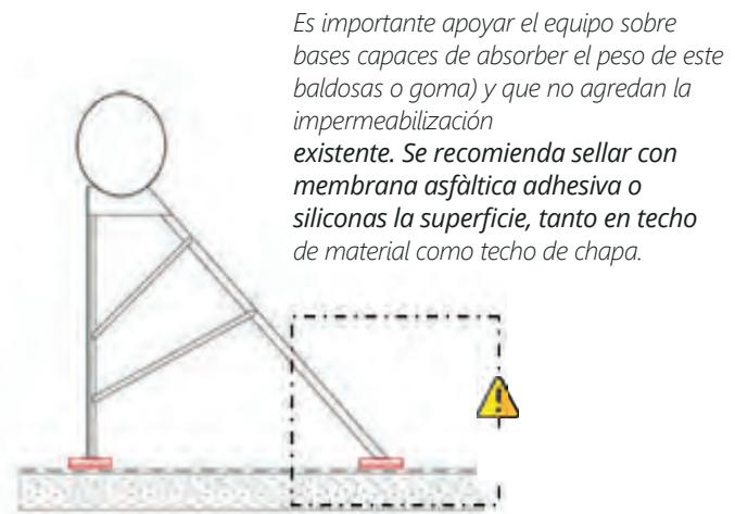
H. En casos donde el lugar de emplazamiento del termotanque solar se debe realizar en techos con inclinación, se recomienda mantener la estructura original y suplementar las patas para que el termotanque quede montado como en una superficie horizontal.
