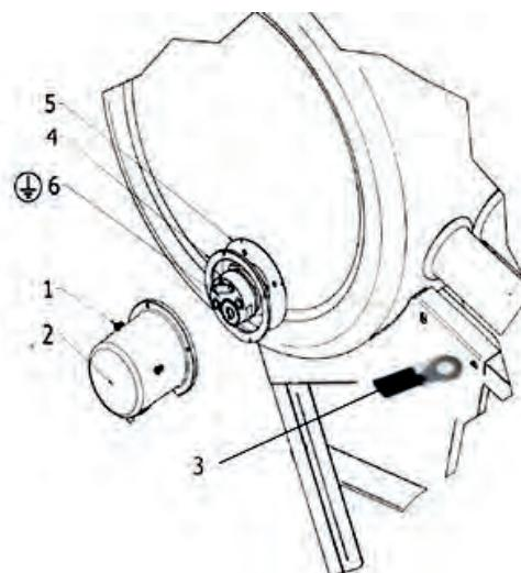
*En uno de los costados del termotanque solar se aloja un orificio con un tapón macho rosca de 1 1/4".*
